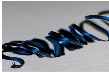
Figura 1. Cavaco azulado no fim da vida da ferramenta
