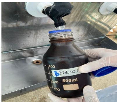
Figura 1: Coleta da água em frascos estéreis
