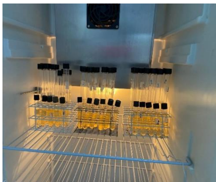
Figura 2: Tubos do ensaio presuntivo incubados Fonte: Elaboração própria
