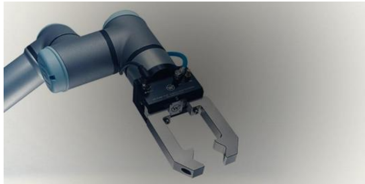
Figura 1 – Garra Pneumática certificada pela Universal Robots
