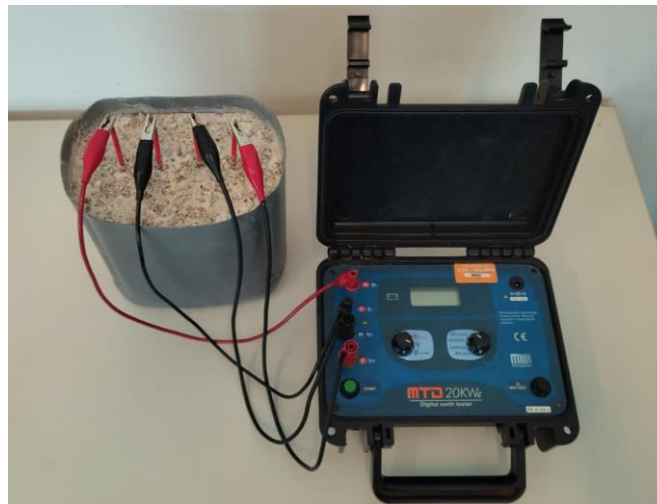
Figura 2 – Medição da resistência elétrica dos corpos de prova dos MMSAE.
