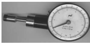
Figura 2 - dolorímetro também chamado algômetro
