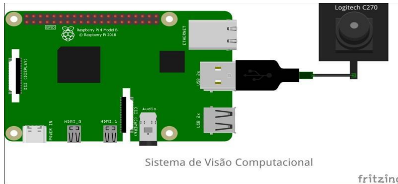
Figura 1 – Esquema de ligação do Raspberry Pi 4 com câmera Logitech C270 HD
