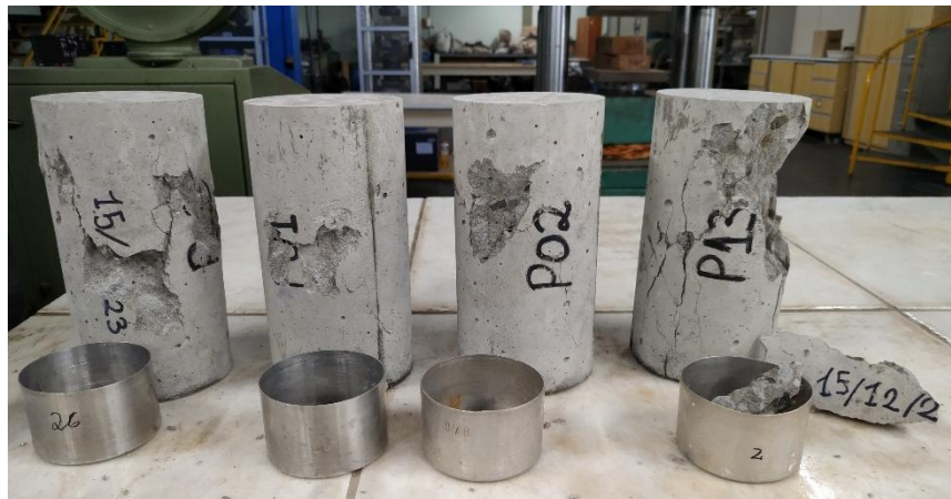
Figura 6: Amostras de ensaio de resistência a compressão.
