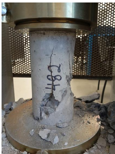
Figura 2: Ensaio de resistência à compressão axial Fonte: Autor (2025)
