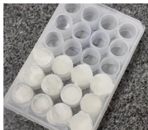
Figura 2 - Hidrogéis à base de biopolímeros naturais após processo de secagem, dispostos em moldes cilíndricos para análises subsequentes.
