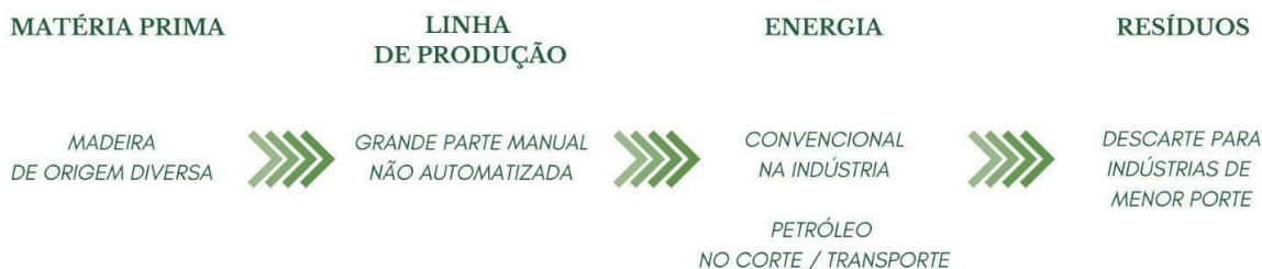
Figura 3: Método de produção convencional adotado pela indústria de MDF Fonte: Autores (2025)
