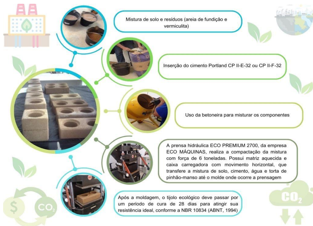
Figura 1: Processo de fabricação do tijolo ecológico
