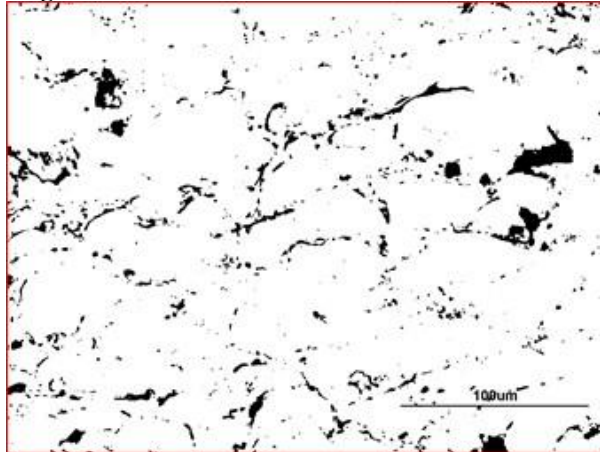
Figura 12 - Poros e Óxidos da Amostra HVOF-420-4.
