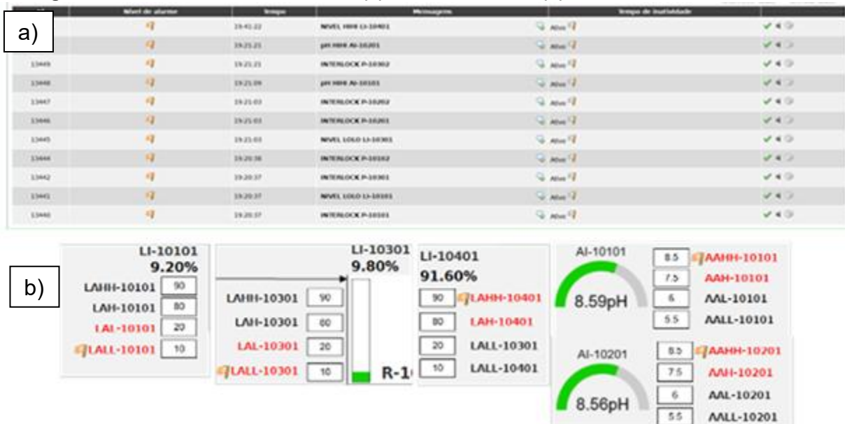
Figura 14 – Verificação dos alarmes: (a) lista de eventos; (b) variáveis com alarme ativo.
