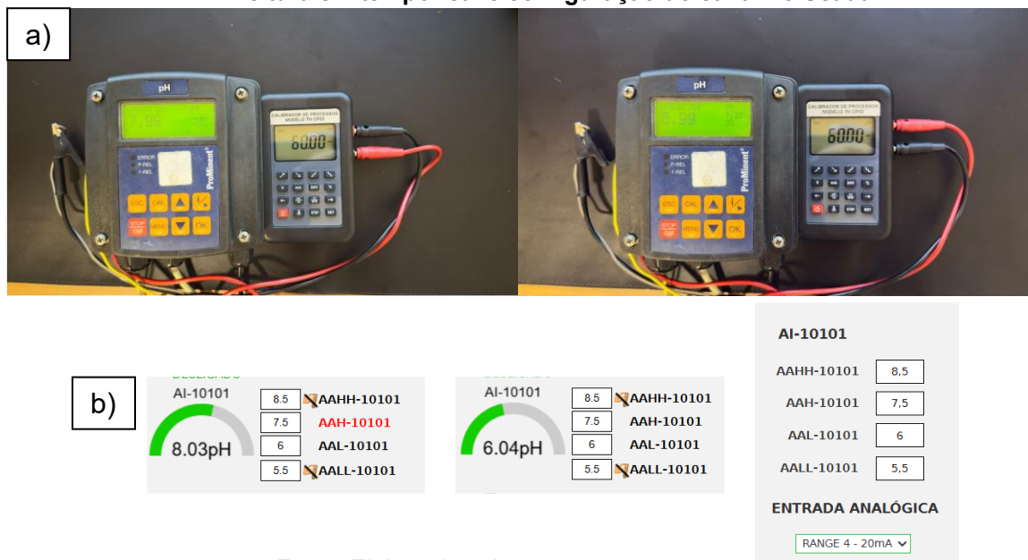
Figura 12 – Teste com transmissor de pH: (a) montagem com sinais de 60 mV e -60 mV; (b) leitura em tempo real e configuração do canal no ScadaBR.
