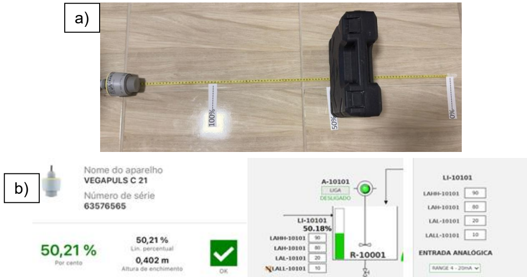
Figura 11 – Teste com transmissor de nível: (a) montagem física com barreira em 50%; (b) leitura via aplicativo Bluetooth e ScadaBR.
