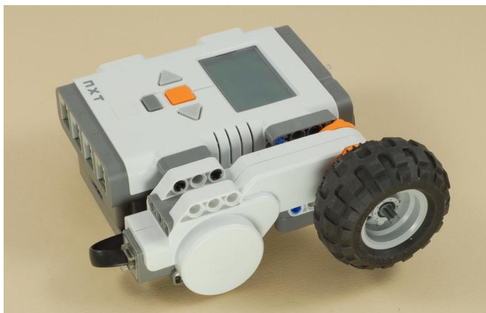
Figura 3 – Calculadora de área e volume com peças do kit NXT
