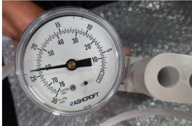
Imagem 4: manômetro pressão de vácuo da válvula geradora
