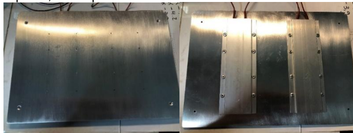
Figura 10 – Placa de alumínio para aquecimento superfície lisa e plana, na esquerda se tem as resistências instaladas.
