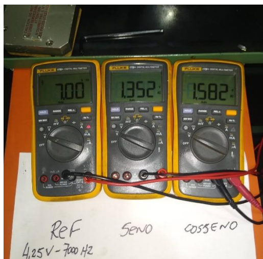
Figura 4- aquisição pontual de dados com multímetros
