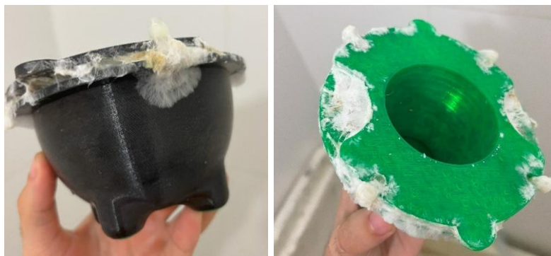
Figura 1 - Colonização do micélio, inserido em moldes feitos com Impressão 3D.
