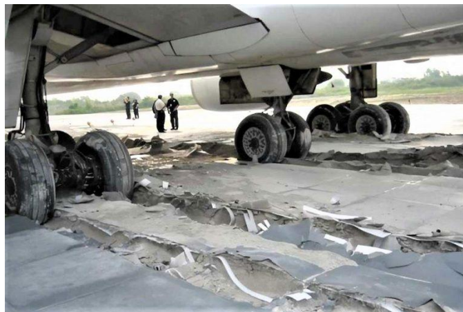
Figure 3: Penetração do trem de pouso no EMAS. Fonte: eBianch (2018).
