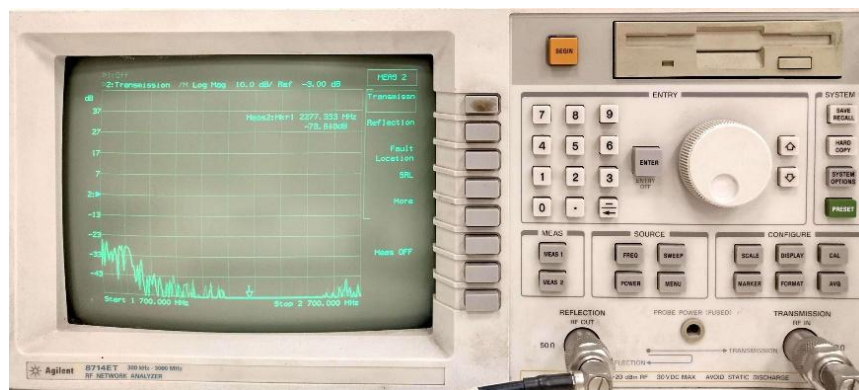
Figura 4: Analisador de Redes. Fonte: Próprios autores 2022.
