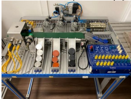
Figura 01 – Planta didática separadora de peças
