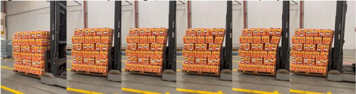
Figura 1: Teste de movimentação de carga (AERO3) sem stretch e sem aplicação de cola
