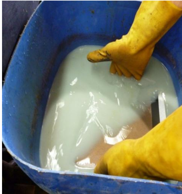
Figura 9 – Imersão de molde em ataque químico
