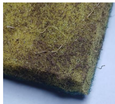
Figura 3. Amostra exposta 3 meses ao solo logo após sua retirada
