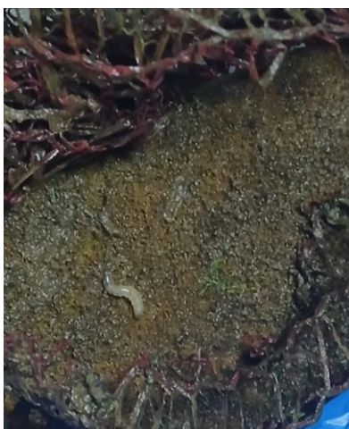
Figura 5. Fotografia da superfície da amostra exposta à lagoa por 3 meses (com a rede nos cantos e a esponja ao centro)
