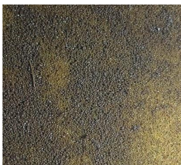
Figura 7. Superfície da amostra exposta ao rio por 3 meses logo após retirada
