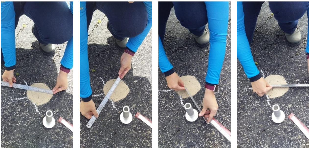
Figura 6: Medição dos diâmetros da mancha com régua metálica. Fonte: Autores (2025).
