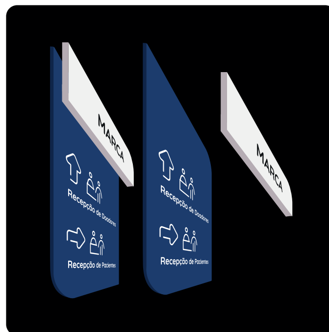
Figura 2: Perspectiva construtiva da placa aérea - materiais: PVC, acrílico e adesivo vinílico.
