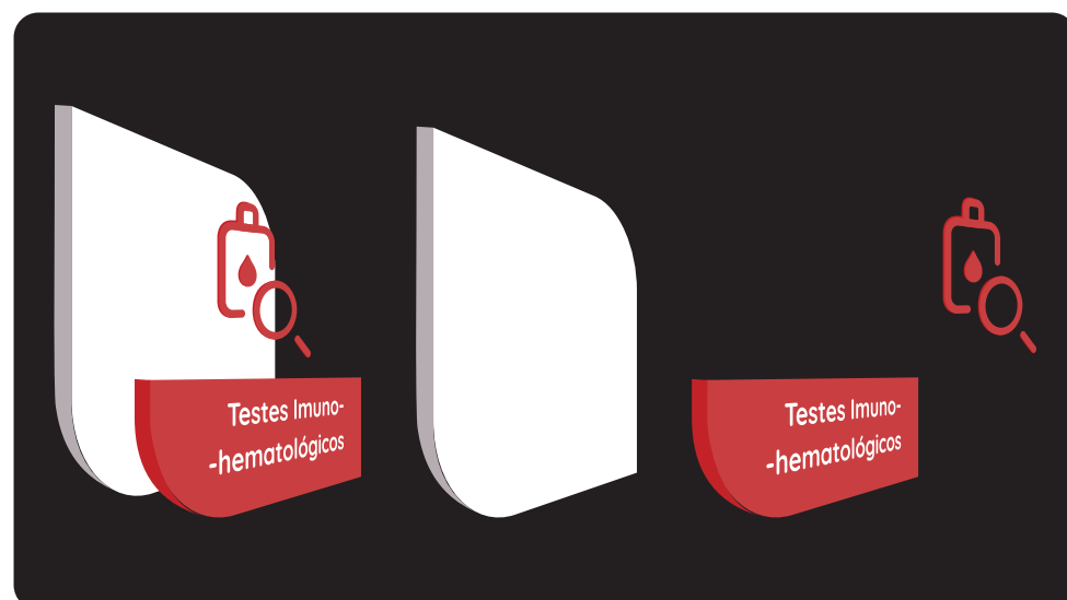
Figura 1: Perspectiva construtiva da placa bandeira - materiais: PVC, acrílico e adesivo vinílico.
