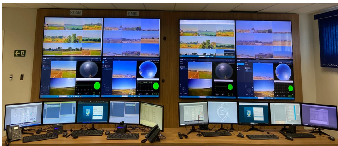
Figura 1: Consoles principal e reserva, na versão 2.0, para a operação e controle dos aeródromos de Campo de Amarais e Franca à partir do Centro Regional de Sorocaba
