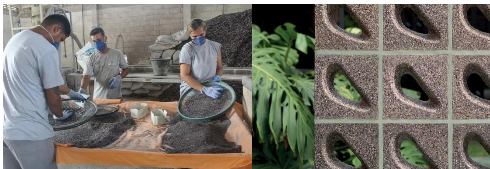
Figura 4A e 4B: processo de preparação do resíduo / resultado final do cobogó mundaú
