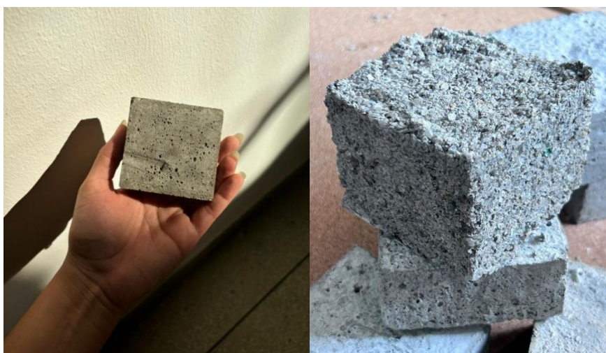
Figura 8A e 8B: protótipos para tijolos menor quantidade de vidro / maior quantidade de vidro
