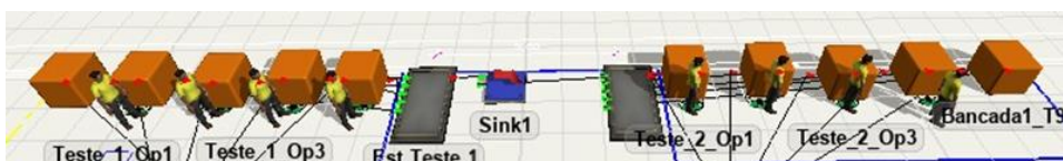
FIGURA 9 - Configuração da linha de produção após a adição de um posto de trabalho no FlexSim®.
