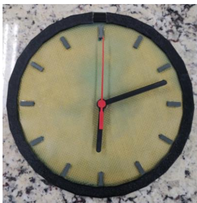
FIGURA 4: Relógio manufaturado com o compósito desenvolvido.
