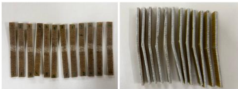
FIGURA 3 - Corpos de prova antes e após o ensaio de flexão.
