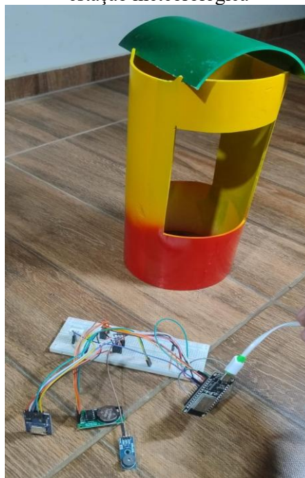
Figura 1: Circuito com o DHT22, módulo RTC, Adaptador de Cartão Micro SD, ESP32 e base da estação meteorológica
