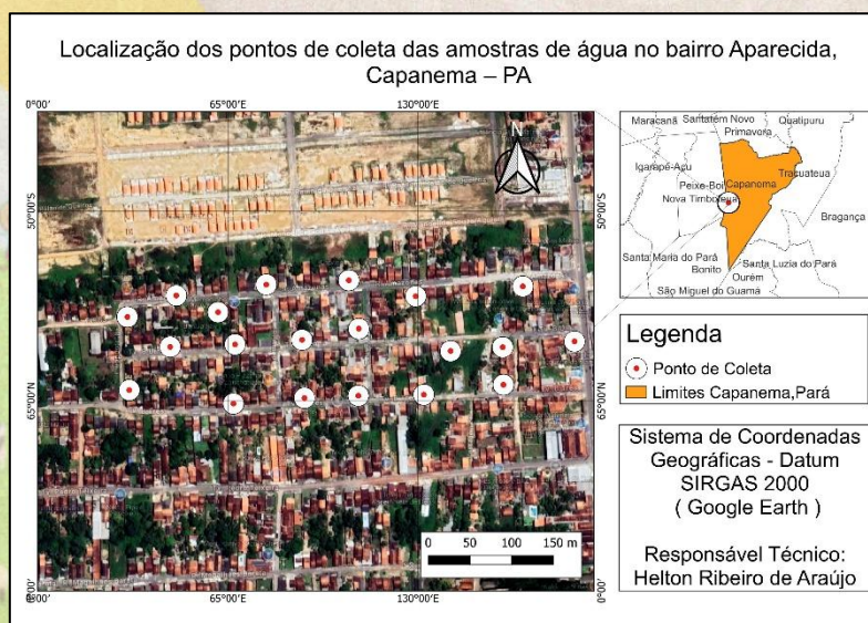
Figura 1 - O mapa apresenta a distribuição georreferenciada dos 20 pontos de coleta de amostras de água utilizadas no diagnóstico físico-químico no bairro Aparecida. A base cartográfica foi elaborada a partir de imagens de satélite obtidas no Google Earth, utilizando o sistema de coordenadas geográficas - Datum SIRGAS 2000.
