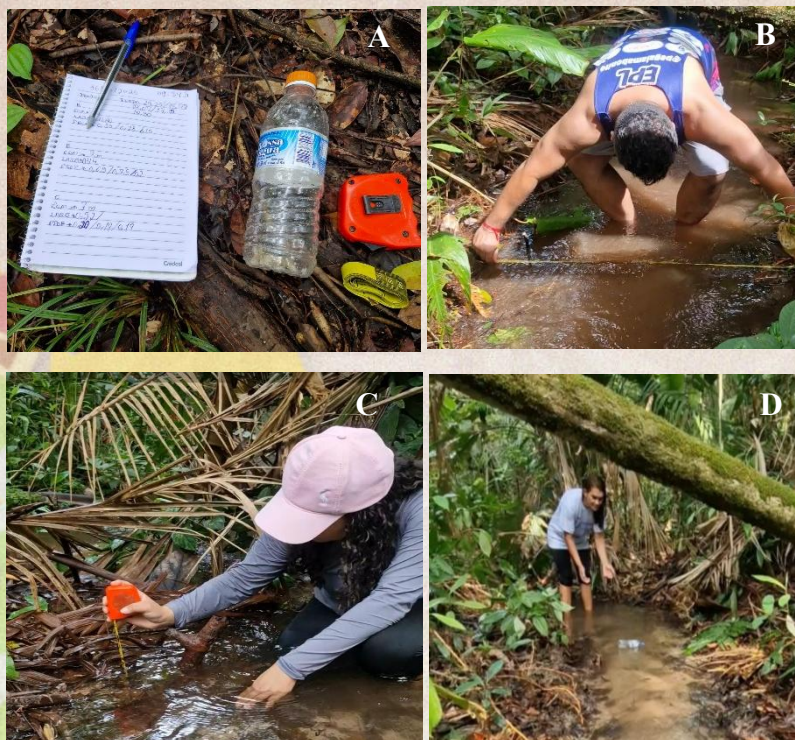
FIGURA 2. Materiais utilizados para coleta dos dados (A) medição da largura do trecho (B), medição da profundidade em (C), velocidade média do fluante em (D).
