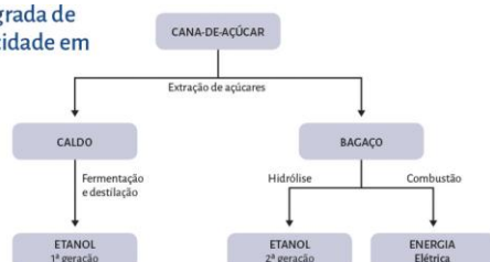
Figura 2. Fluxograma de etapas da produção até a cinzas do bagaço de cana-de-açúcar.
