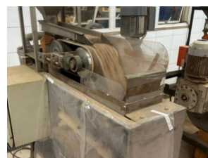
Figura 10. Tambor magnético 1400 Gauss (Modelo RE) (Santos, 2024)
