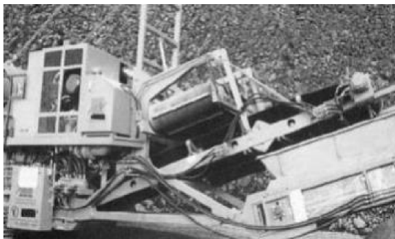
Figura 4. Separador magnético Steinert de correia cruzada (Svoboda, 2003)
