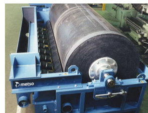
Figura 7. Separador magnético de tambor LIMS em operação industrial (Metso, 2025)
