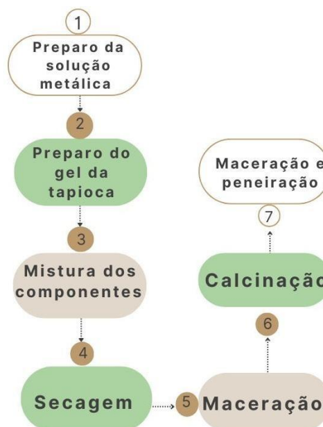
Figura 3. Fluxograma do processo de síntese de \text{CoFe}_2\text{O}_4 pelo método sol-gel.
