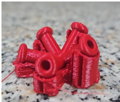
(a) Detalhe dos vértices conectores.
