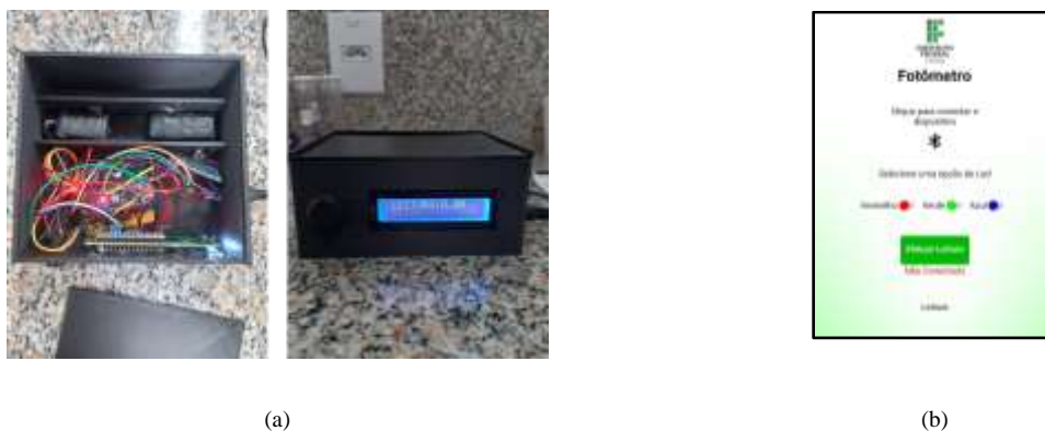
Figura 1 – Fotômetro (a) Estrutura e componentes; (b) Interface do aplicativo responsável pelo controle do equipamento.
