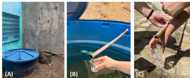
Figura 1 – Pontos de captação da água condensada nos sistemas de drenagem: (a) saída do bloco A; (b) saída da biblioteca do campus; (c) saída do refeitório.
