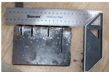
Figura 3 – Peça utilizada para o ensaio do chanfro.
