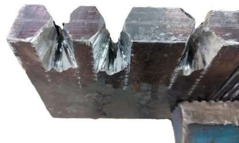
Figura 4 – Chanfro preparado na amostra de aço.
