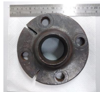
Figura 2 – Flange de aço carbono ASTM A105.
