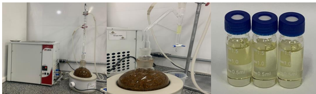
Fig. 2- Destilação tipo Clevenger para extração de óleo
