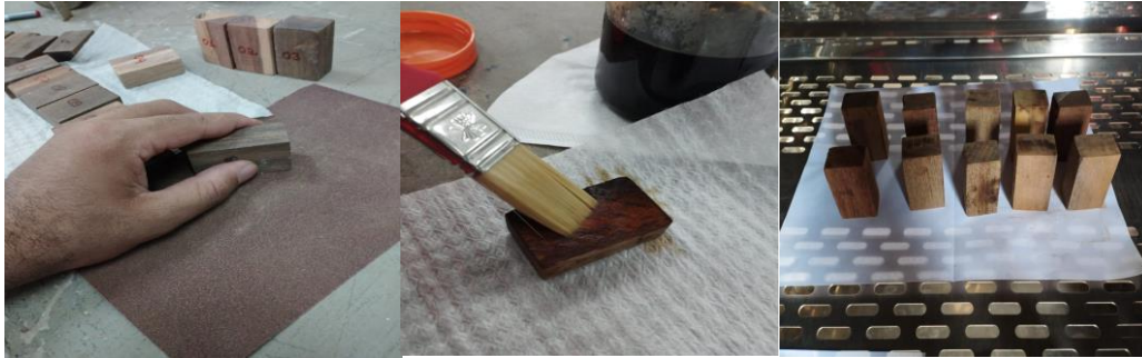
Fig. 3- Preparação dos corpos de prova
