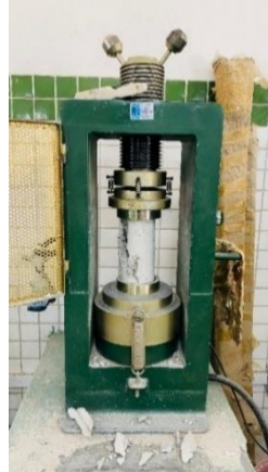
Figura 1 – Rompimento de corpo de prova
