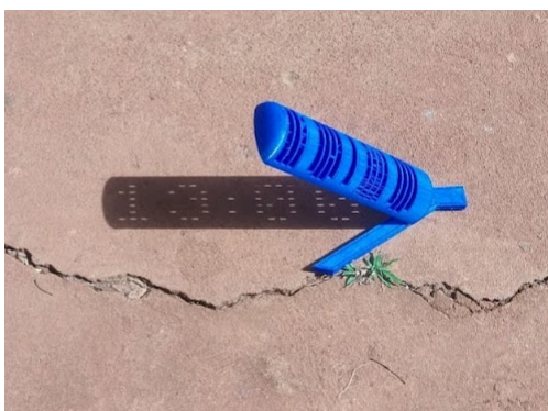
Figura 3. Protótipo de um relógio solar digital impresso em 3D.
