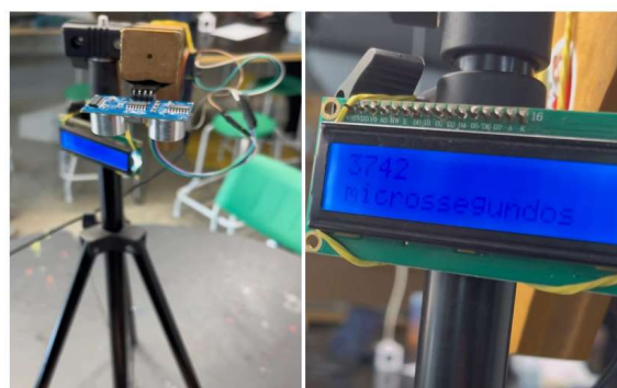
Figura 7. Sensor Ultrassônico Mostrando o Tempo de Reflexão de Uma Onda Sonora em Microssegundos
