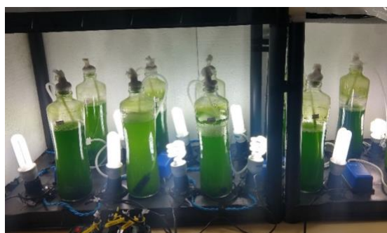
Figura 1: Aparato experimental geral com destaque para os fotobiorreatores.
