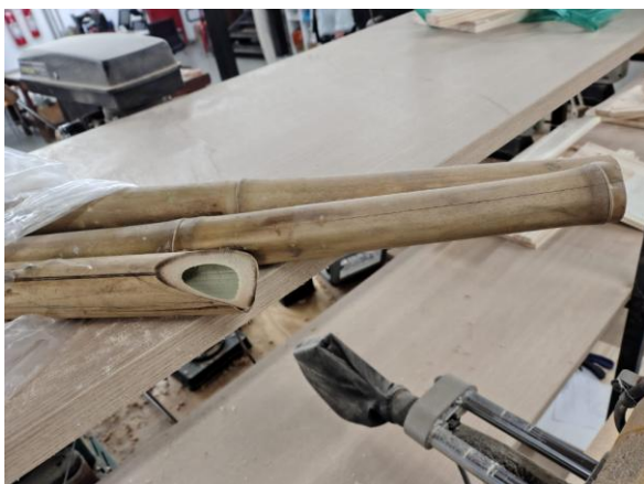
Figura 3 - Lâmina de bambu – beneficiamento para substituição de madeira de lei. Fonte: Imagens de Celio Matta (2025).
