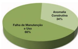
Gráfico 1. Distribuição da incidência dos acidentes prediais por tipo de origem.
