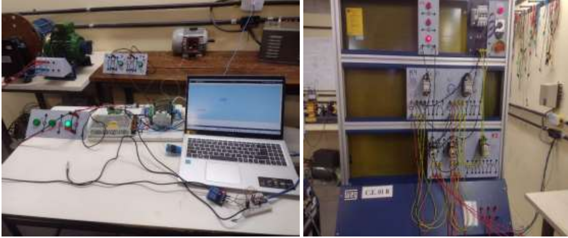
Figura 3 – Montagem física da partida sequencial de dois motores.
