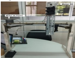
Figura 1 - Estrutura da maquete com os motores de passo e DC nos eixos x e y.
