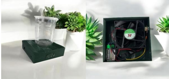
Figura 1 - Protótipo de agitador magnético desenvolvido por impressão 3D, utilizando componentes reaproveitados.
