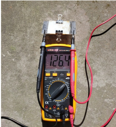
Figura 2 – Medidas de tensão em circuito aberto e corrente de curto-circuito para a célula solar realizadas em momentos distintos.
